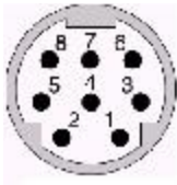
8 针圆形母座管脚图 (注意公头管脚左右顺序相反)
